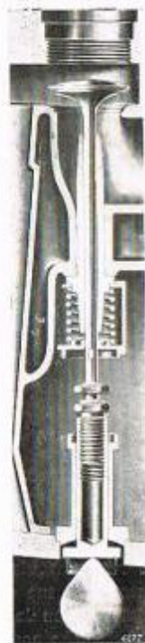
Fig. 36. — Position de la soupape pour l'engagement du demi-cylindre.
